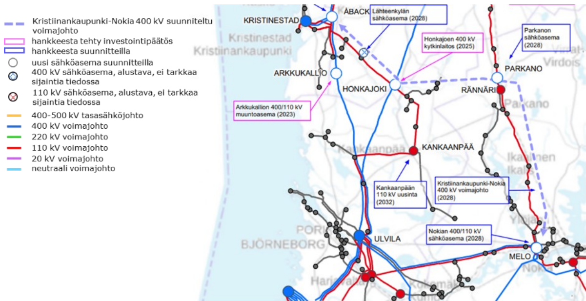
Kuva 19: Seinäjoki-Pori seudun Fingridin kantaverkon kehittämissuunnitelma 2024–2033 (Fingrid, 2023c)
