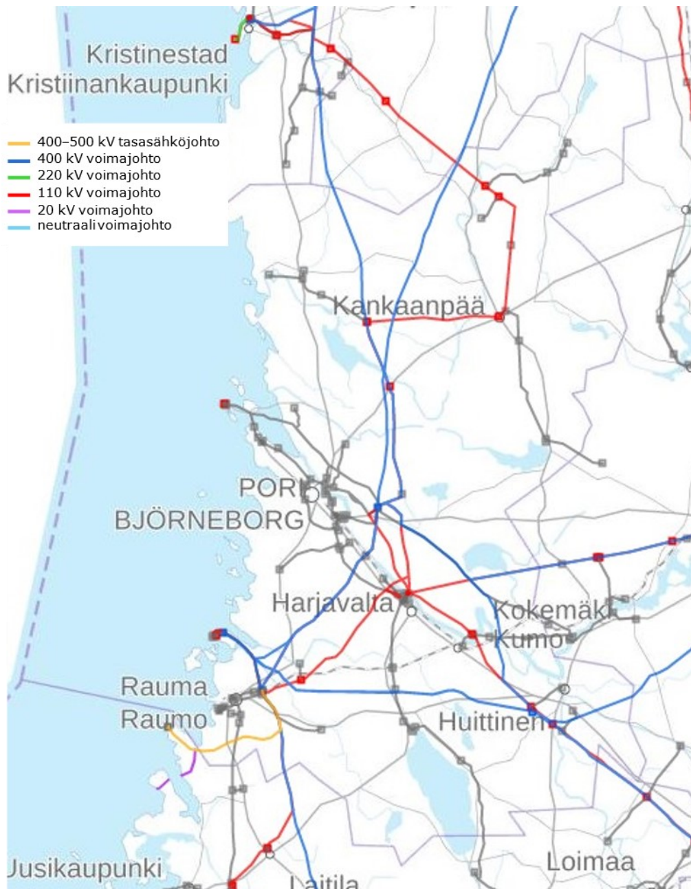
Kuva 14: Satakunnan sähköverkon nykytilanne. Keltainen väri kuvastaa 400–500 kV tasasähköjohtoa, sininen 400 kV, vaalean vihreä 220 kV, punainen 110 kV, violetti 20 kV ja vaalean sininen neutraalia. Kuvasta huomioitavaa, että osa johtimista kulkee vierekkäin, mutta kuvassa näkyy silti vain yksi väri. (Fingrid, 2023d)
