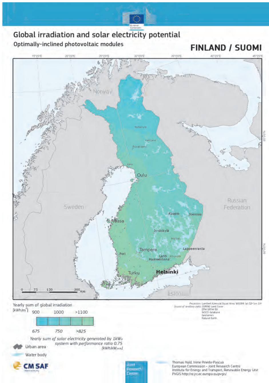
Kuva 19. Globaalisäteilyn määrä vuodessa (kWh/m 2 , väriskaalan yläpuolinen asteikko) sekä optimaalisesti asennetuilla aurinkopaneeleilla saavutettava vuosituotanto tehoyksikköä kohden (kWh/kW p , väriskaalan alapuolinen asteikko). (Kartta: Šúri 2007; Huld 2012 / IET) 25
